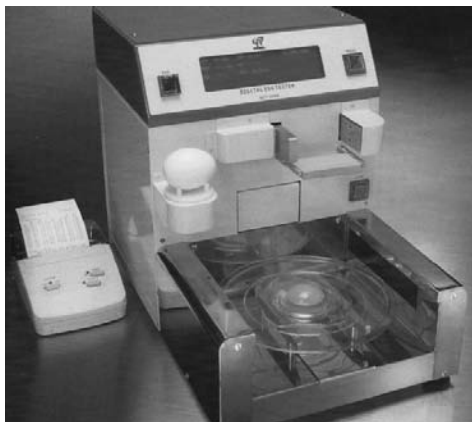
Рис. 12 Цифровой тестер DET 6000 для опреде- ления качества яиц
