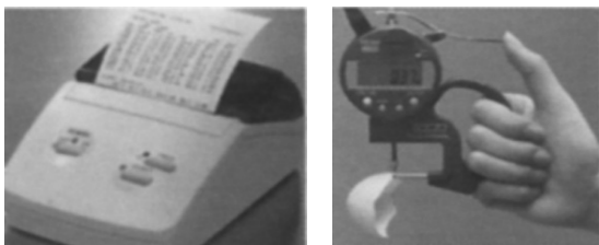
Рис. 13 Прибор для определения толщины скорлупы
